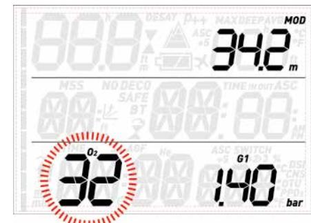
Kad ste u ovom izborniku, pritisnute tipku **UP** ili **DOWN** za promjenu O<sub>2</sub>% i pratite kako se to održava na maksimalnu radnu dubinu (MOD). Zatim pritisnite tipku **ENTER** za prelazak na ppO<sub>2</sub>max i koristite tipku **UP** ili **DOWN** za promjenu vrijednosti te ponovno pratite kako se to odražava na MOD. Ponovno pritisnite tipku **ENTER** za spremanje postavke.
