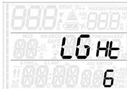
Quad ima pozadinsko osvjetljenje koje se može uključiti u slučaju slabog ambijentalnog osvjetljenja. Pozadinsko osvjetljenje uključuje se pritiskom i držanjem gornjih tipki. Tijekom ronjenja, pozadinsko osvjetljenje ostat će uključeno kroz vrijeme određeno u ovom izborniku. Možete odabrati između 1 i 10 sekundi ili postaviti na **on**. Ako ga postavite na **on**, pozadinsko osvjetljenje ostat će uključeno dok ponovno ne pritisnete i držite bilo koju od gornjih tipki.
