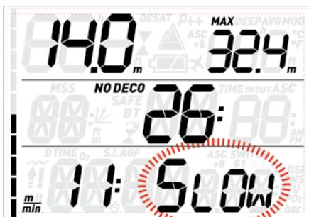
Ako brzina izrona prijeđe 12m/min / 40ft/min na dubini većoj od 12m / 40ft, **!!** također bljeska. Ako brzina preko 12m/min / 40ft/min potraje dvije trećine ili više dubine na kojoj je alarm prvi put aktiviran, Quad to smatra kršenjem zarona i na zaslonu će stalno biti prikazano **!!**.
