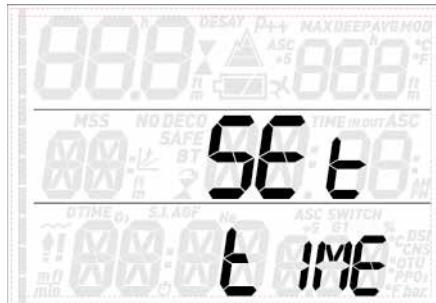
Ovaj izbornik omogućuje vam postavljanje formata vremena i datuma. Pritisnite tipku **ENTER** i **24h** ili **AMPM** će početi bljeskati. Pritisnite tipku **UP** ili **DOWN** za prebacivanje između dvije opcije i/ili pritisnite tipku **ENTER** za potvrdu i prelazak na postavljanje sati, minuta i datuma.
